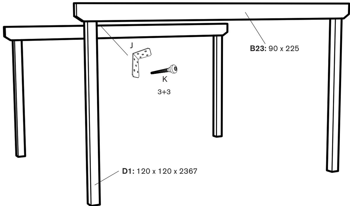
Som alternativ till vinkelbeslag kan skråskruvning användas för att montera ihop komponenter i stommen
