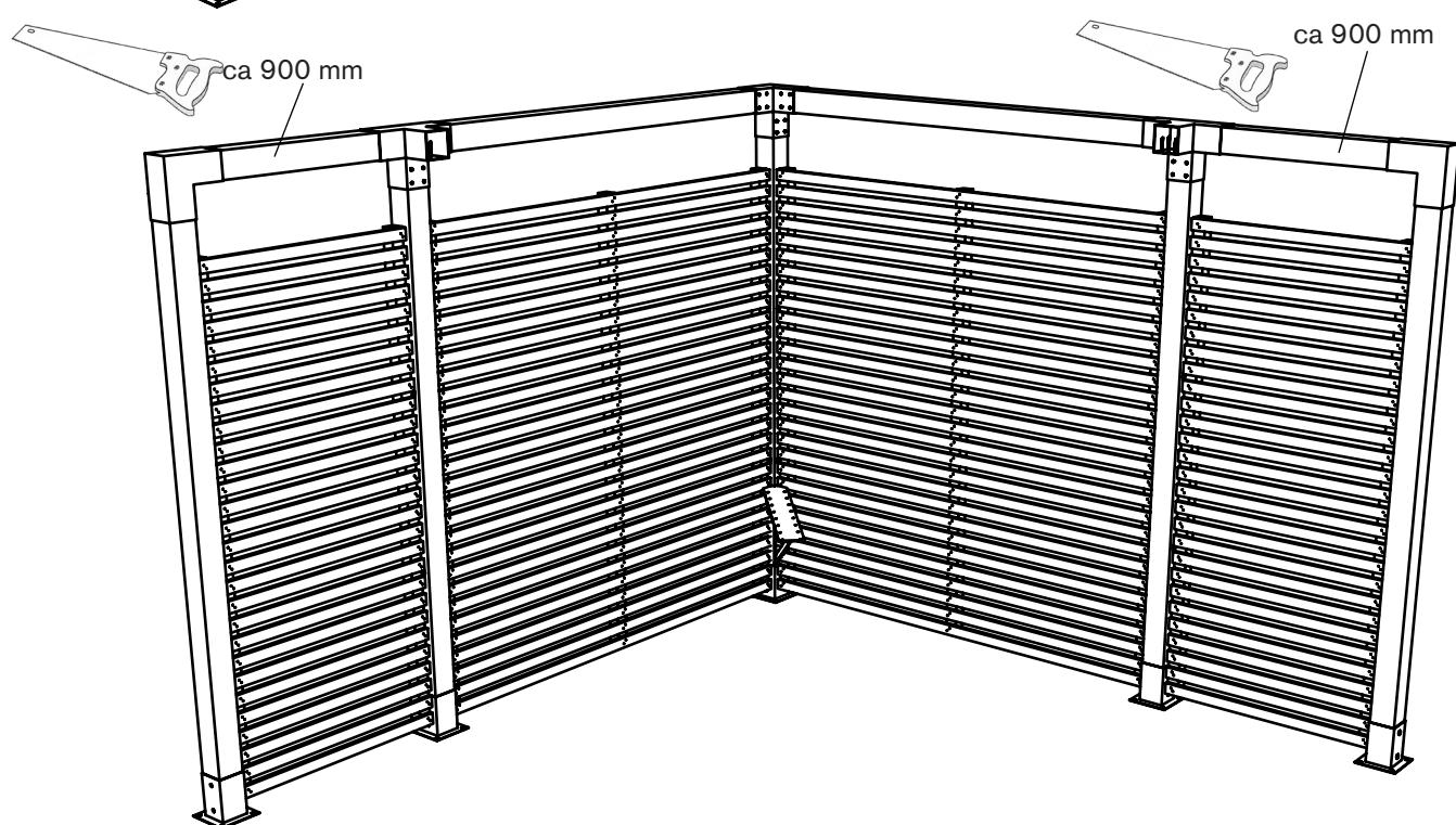
**SE** Monter det yttre hörnet. Se nu till att hela konstruktionen är rak och fäst in stolpar i stolpskor. (skruv ingår ej) Fäst alla övre beslag med skruv 5x50.
