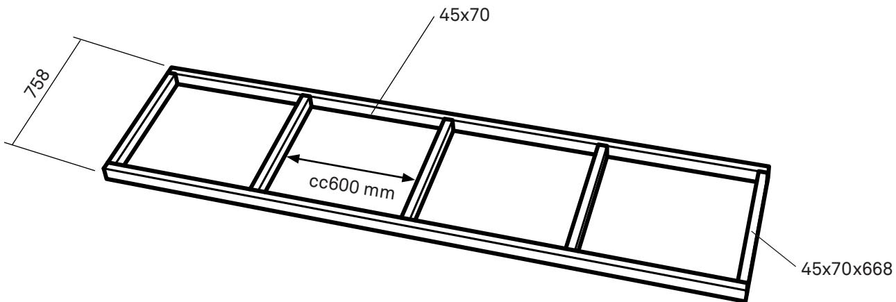
**SE** Såga till och montera kortlingar med skruv 5x80.
