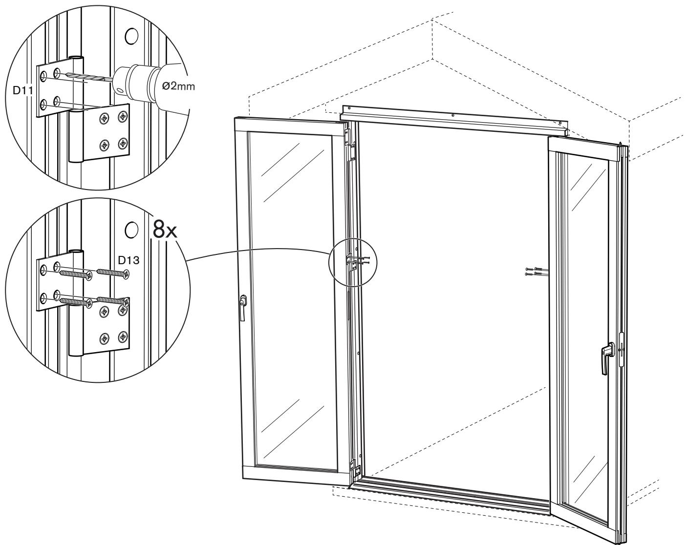
**SE** Kontrollera att spelet mellan lucka och karm är jämnt över och under partiet. Spelet skall vara ca 5mm. Vid behov justera luckan genom att luta karmsidan något med hjälp av karmskruven D61.
