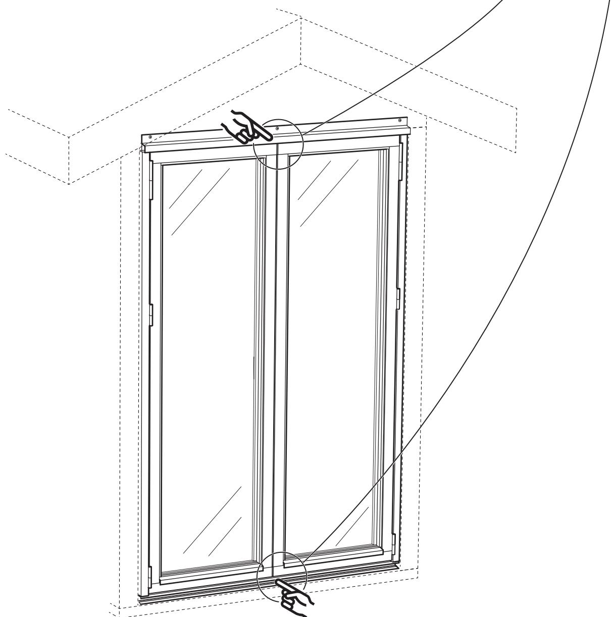
**SE** Monter stödklacken D25 under luckans spanjolett. Linjera med det stansade hålet i tröskelprofilen, och tryck fast stödklacken. Spanjoletten ska gå igenom stödklacken när handtaget är i låst läge. Montera täckplugg D102
