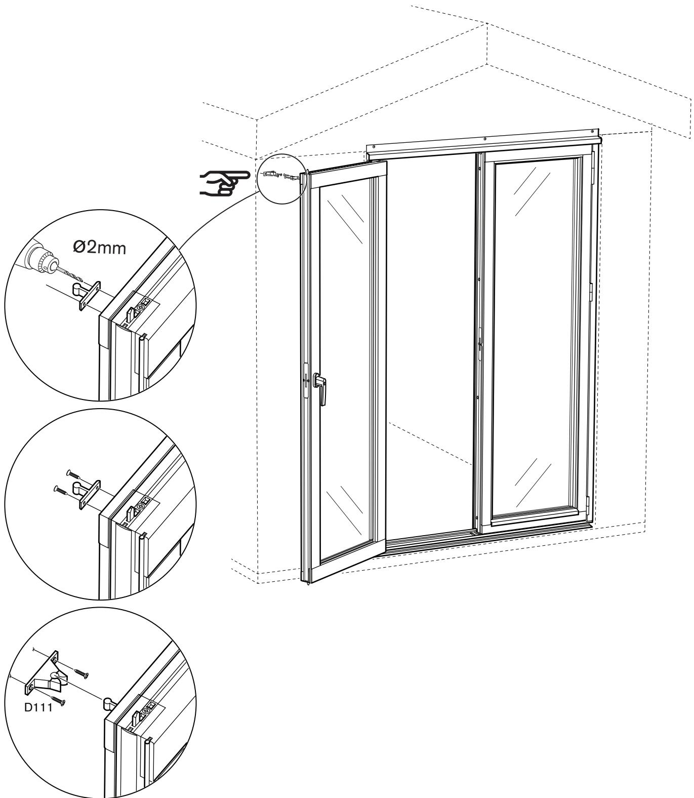
**SE** Montera L-list A2 i spåret i aluminiumbeklädnaden runt om luckan (Gäller endast partier med aluminiumbeklädnad). Listen monteras i sidorna och upptill på luckan.
