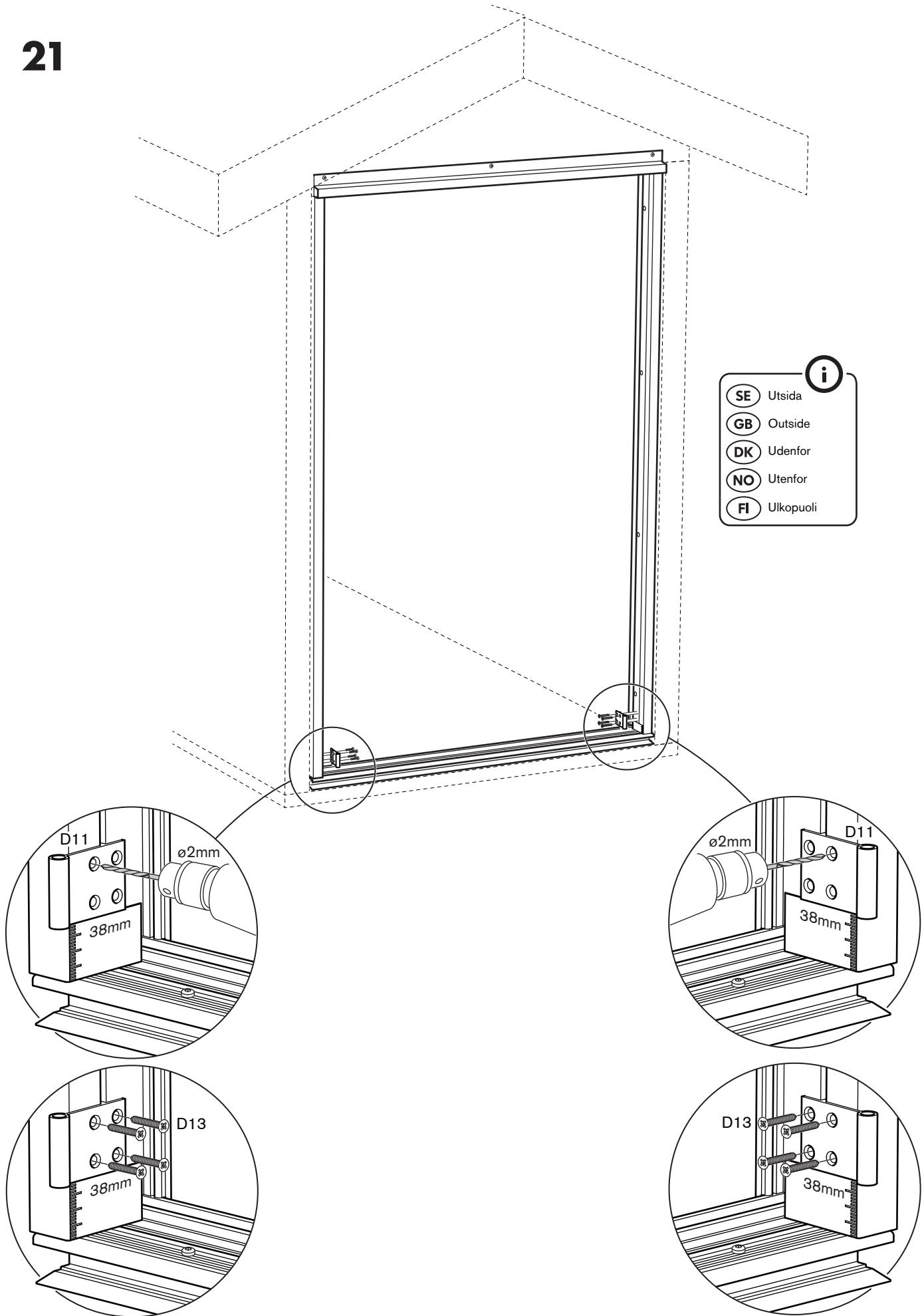
**SE** Använd en regel som är lika hög som avståndet mark till ovanskant tröskel, lägg denna ca en halv meter utanför partiet. Denna är till för att ställa dörrarna på medan beslagen monteras. Sätt i gångjärnstappen D12 i undre gångjärnet och lyft på luckan.
