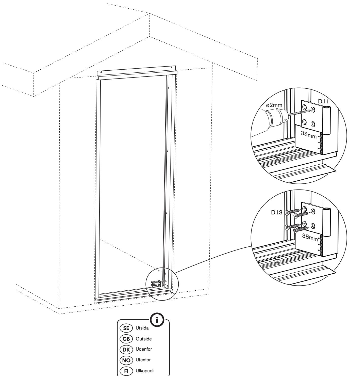
**SE** Använd en regel som är lika hög som avståndet mark till ovanskant tröskel, lägg denna ca en halv meter utanför partiet. Denna är till för att ställa dörrarna på medan beslagen monteras. Sätt i gångjärnstappen D12 i undre gångjärnet och lyft på luckan.
