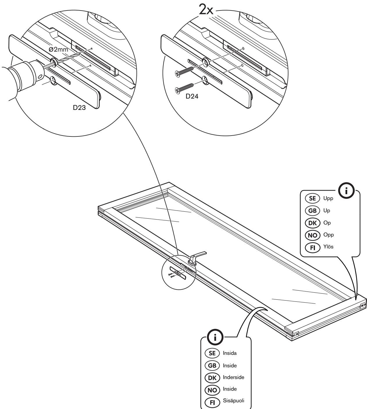
**SE** Monter gångjärnen D11 och D15 med gångjärnskrub D13 enligt bilder nedan. OBS! Det är viktigt att gångjärnen kommer på rätt höjd och att man förborrar med 2mm borrh för att undvika att träet spricker. Använd bifogade mallar för rätt placering av gångjärn.
