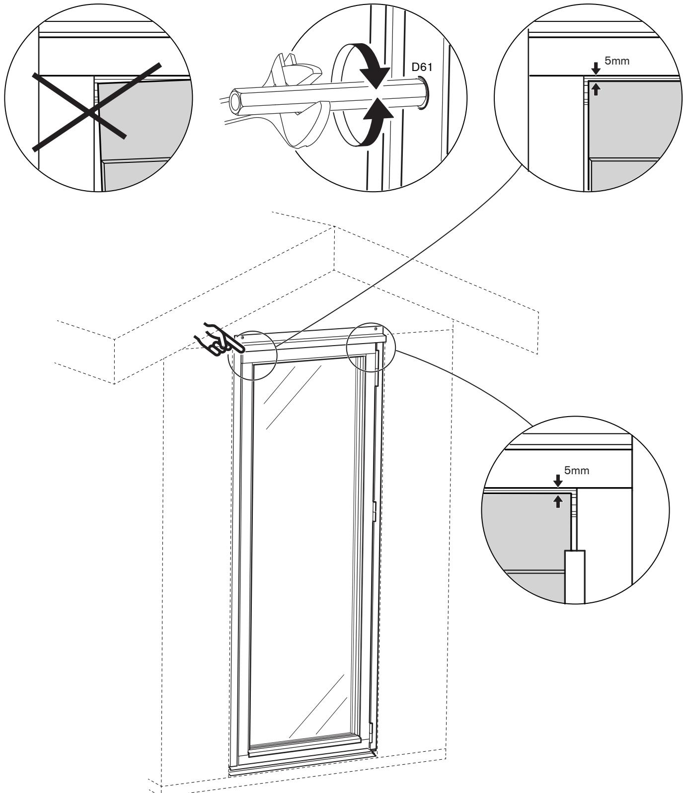
**SE** Montera stödklacken D25 under luckans spanjolett. Linjera med det stansade hålet i tröskelprofilen, och tryck fast stödklacken. Spanjoletten ska gå igenom stödklacken när handtaget är i låst läge. Montera täckplugg D102
