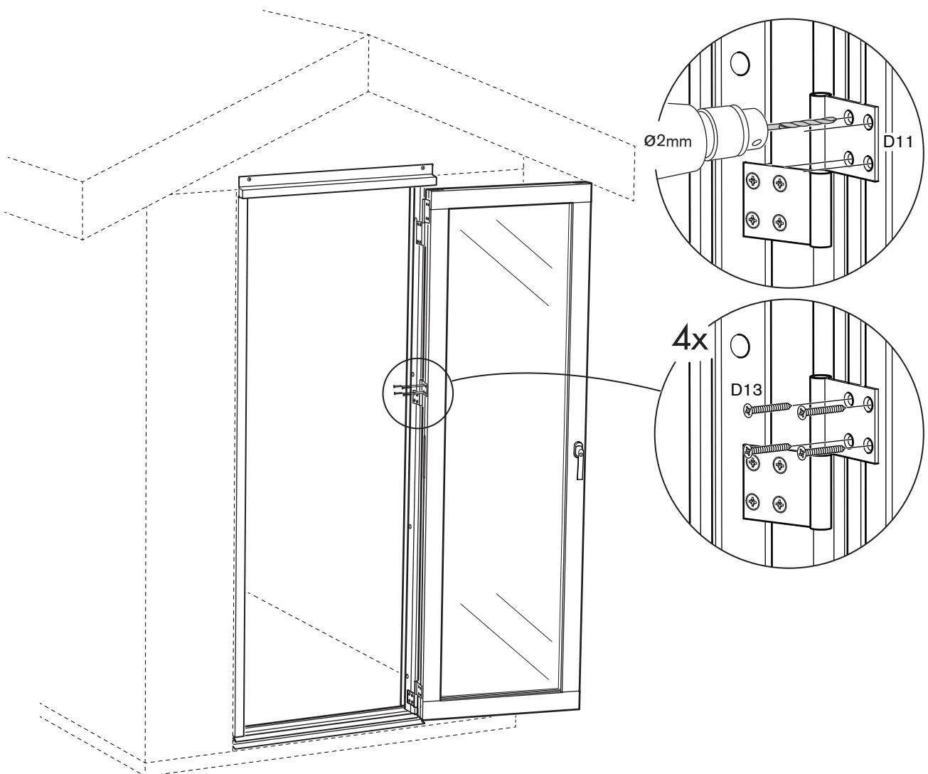
**SE** Kontrollera att spelet mellan lucka och karm är jämnt över och under partiet. Spelet skall vara ca 5mm. Vid behov justera luckan genom att luta karmsidan något med hjälp av karmskruven D61.
