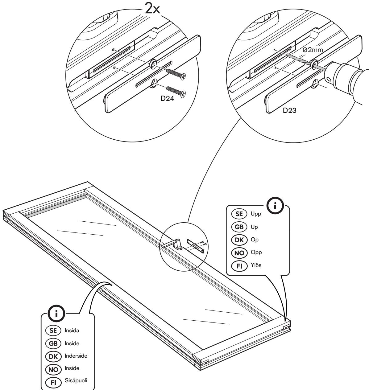
**SE** Monter gångjärnen D11 och D15 med gångjärnskrub D13 enligt bilder nedan. OBS! Det är viktigt att gångjärnen kommer på rätt höjd och att man förborrar med 2mm borrh för att undvika att träet spricker. Använd bifogade mallar för rätt placering av gångjärn.
