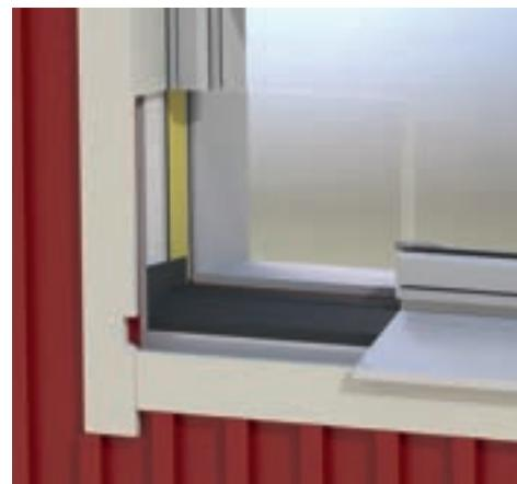
Fig 2. Snitt av vindu i vegg med fuging, sekundærtetting, vannbrettbeslag mm.
