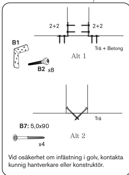
**SE** Som alternativ till vinkelbeslag B1 kan skräckravning användas för att montera ihop komponenter i stommen.
