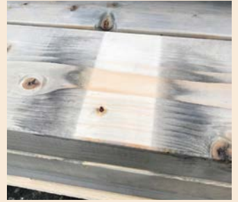
Impregneringsvätska når inte alla ytor
