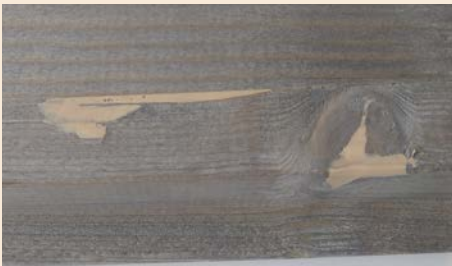
Ytbehandlad med träspackel på doppimpregnerat trä
