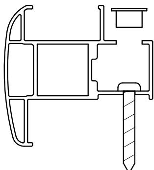
Skru fast døra og dekk hullet med dekkplugg som følger med.
