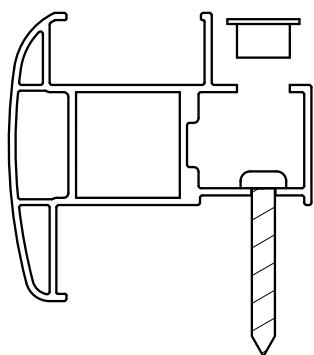
Skruva fast luckan och täck hålet med medföljande täckplugg
