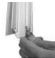
Sæt profilerne sammen ved at føre firkanthovedboltene ind i profilkanten og sæt dem i hullet i den tilsvarende stang. Møtrikkerne må ikke strammes helt, før det færdige stel er retvinklet. **VÆR OPMÆRKSOM PÅ, AT ALLE FORBUNDNE PROFILER SKAL FLUGTE OG SIDDE STRAMT SAMMEN FOR AT SIKRE, AT DER ER MINDST MULIGE UTÆTHEDER.**
