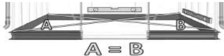
Prendere nota di dove si dovrà far entrare dei **bulloni aggiuntivi** nei canali per il fissaggio di barre orizzontali, rinforzi o sfati del tetto come da esempio nella foto a destra. Fissare insieme i profili facendo scorrere le viti a testa quadrata nel canale del profilo e collegarle al foro della barra corrispondente. Non stringere i dadi completamente fino a quando il telaio non sarà completamente quadrato. **OCCORRE**
