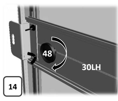
SQUEEZE LEVER & SLIDE OUT TO REMOVE AS LEFT
