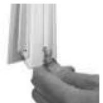
Fest profilene sammen ved å føre boltene med firkanthode inn i profilenes spor og feste dem i hullene i tilstøtende stenger. Stram ikke mutterne helt til før hele rammen er i rett vinkel. **VÆR OPPMERKSOM PÅ AT ALLE TILSTØTENDE PROFILER MÅ VÆRE I FLUKT OG SITTE TETT SAMMEN FOR Å SIKRE AT LEKKASJER HOLDES TIL ET MINIMUM.**
