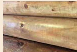
Det har vært vanskelig for brun farge å trenge inn i emballerte stolper.
