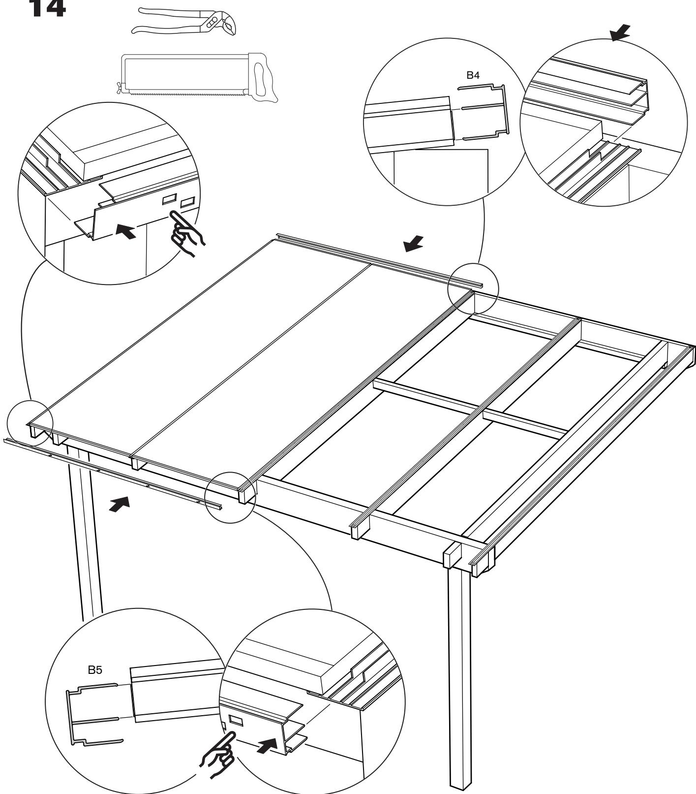
**SE** Monteras kanalplasttaket på ett fristående uterum rekommenderas följande placering av End-profil B4.
