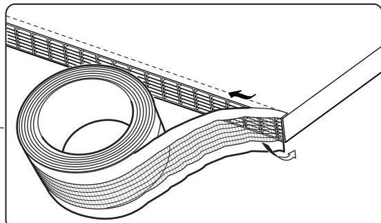
**SE** Kronlisten levereras på 5 meters rullar. Montera första längden. Använd sedan biten som blir över som start till nästa längd. På detta sätt blir det endast max en skarv per längd. (Denna skarv pressas samman vid montering och påverkar ej tätheten i taket.)
