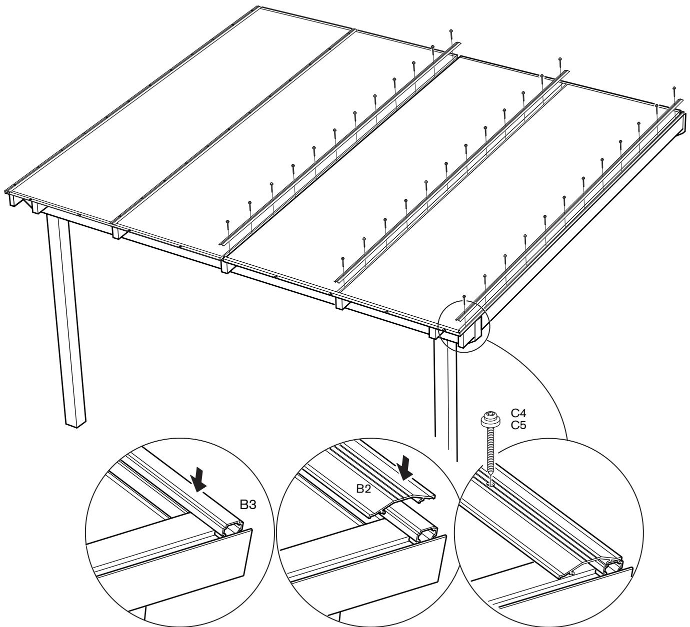
**SE** Täta skarven mellan skiva och profil B4 & B5 med en tunn silikonsträng. Låt silikonen gå upp ett par cm längs profil B2.
