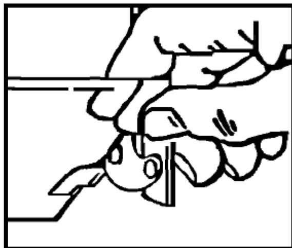
5. Til sidst monteres det glas, som De har afmonteret. Profilerne bør afrenses for silicone, før De begynder på montage af glasset igen. Det kan være nødvendigt at tilpasse et enkelt stykke glas afhængig af, hvilken model drivhus De har.
