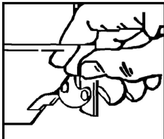
5. Zu letzt wird das Glas, welches Sie entfernt haben, wieder montiert. Die Profile werden vorab gereinigt bzw. Siliconreste werden entfernt. Die Glasscheibe muss angepasst werden, je nachdem welches Modell Sie besitzen.
