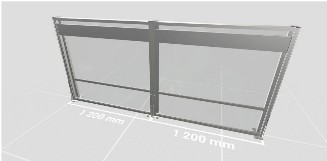
(SE) Här behövs fyra klämfötter samt en fästlist i mitten. Om det finns möjlighet att fästa i en vägg behövs även två justerbara fästplattor
