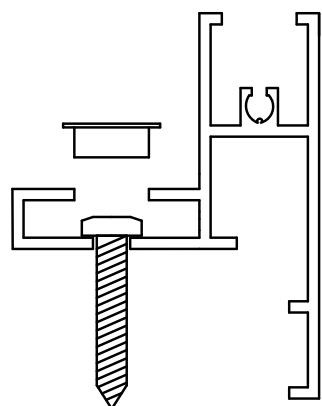
Skruva fast luckan och täck hålet med medföljande täckplugg
