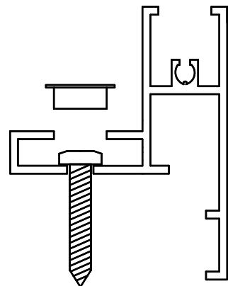
Skru fast døra og dekk hullet med dekkplugg som følger med.
