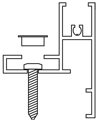
Ruuva ovi/ikkuna kiinni ja peitä reikä toimitukseen sisältyväällä peitetulpalla.
