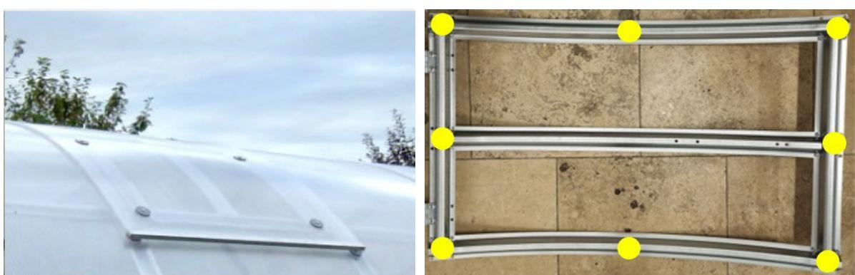
Montering av automatisk vindusåpner (tilleggsutstyr).
